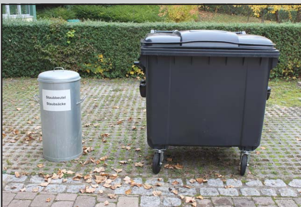
Abb. 9 Geschlossene Abfallbehälter, wie sie zur Entsorgung von Schleifstaub verwendet werden.
