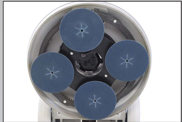
Abb. 2 Einscheiben-Schleifmaschine mit Mehrfachteller.
