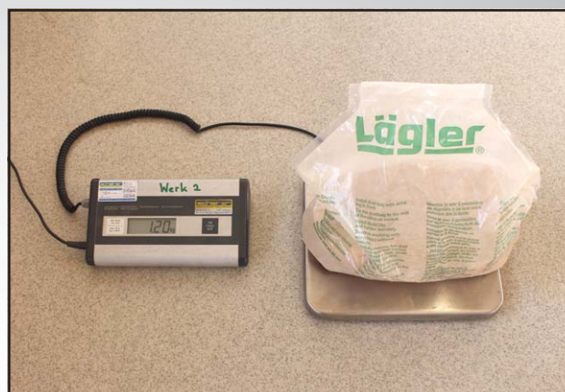
Abb. 4 Wiegen der Staubbeutel nach dem Schleifen.
