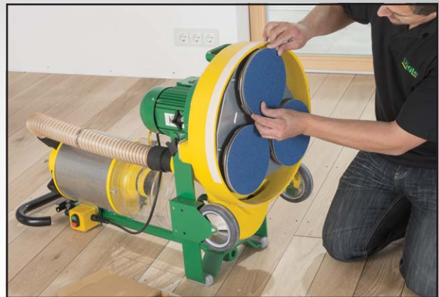
Abb. 8 Schleifmittelwechsel bei der TRIO.
