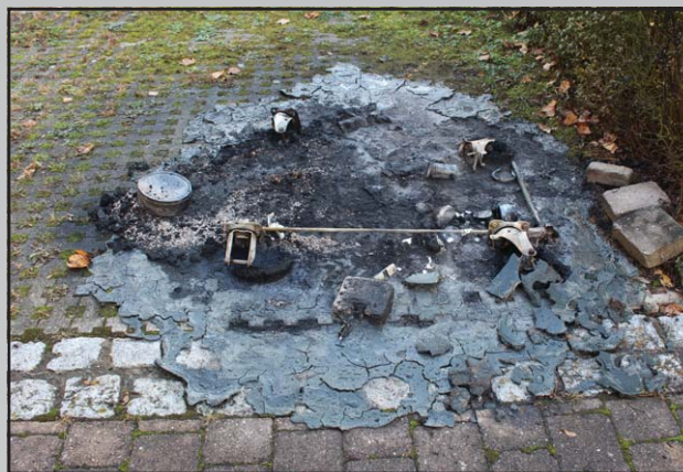
Abb. 10 Überreste des geschmolzenen Behälters in einem ungefährdeten Bereich.
